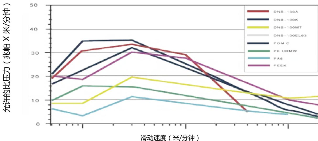
滑动速度在10米/分钟以内，YCB200K的PV值比PEEK和PEUHMW（超聚乙烯）更高。对于滑动状态使用PA6不如使用YCB200K效果好。
