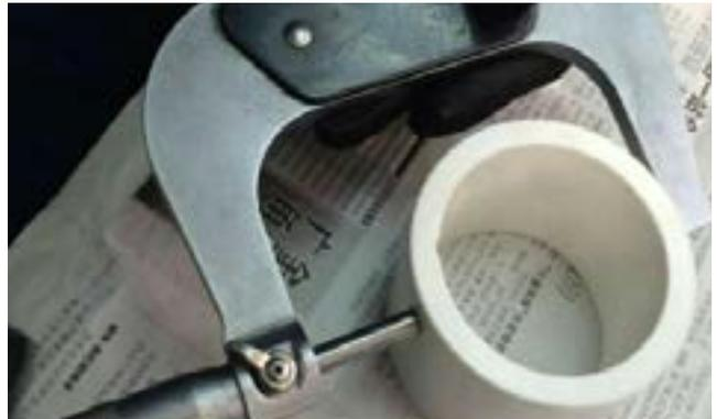
YCB200试验轴套在低温下冷冻，尺寸受冷收缩约为0.08mm，拿出后放置在常温状态下尺寸自然恢复到原状，此试验证明YCB200的产品可以和金属轴套一样进行液氮冷冻安装，避免敲击安装对产品尺寸的破坏。
